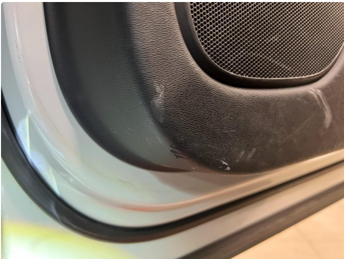
2.1 Skadet/merker etter utstyr
