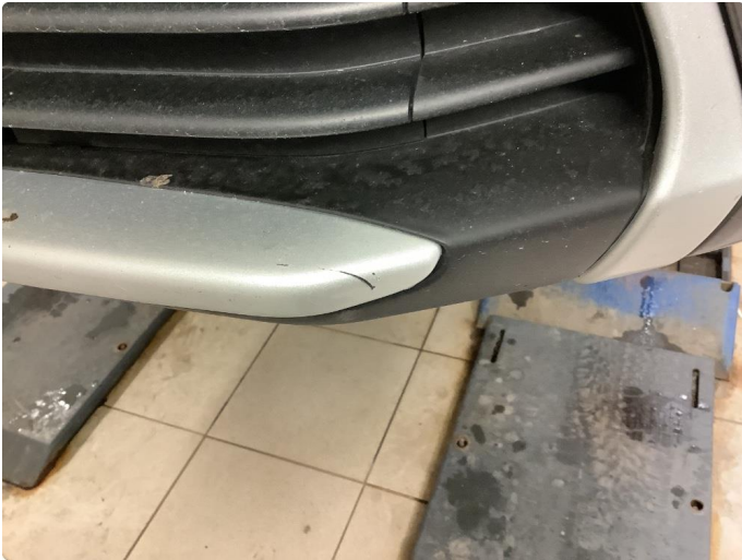
1.1 Noen Små riper og småbulker
