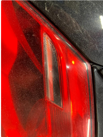
1.1 Litt dugg/fukt i lykt høyre bak.
