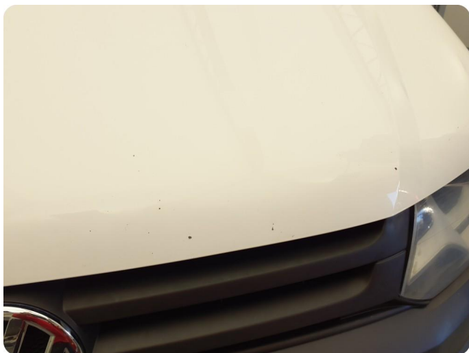
3.1 Øvrige feil Rust, riper, bulker. Hele bilen
