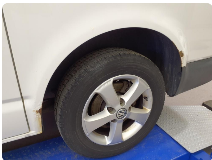
3.1 Øvrige feil Rust, riper, bulker. Hele bilen
