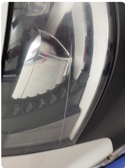
4.1 Defekt/sprukket glass Tillegg riper høyre
