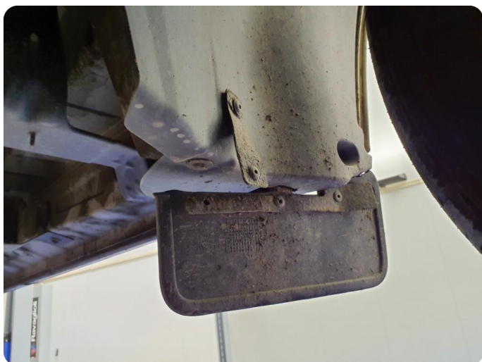
3.2 Beskyttelsesplate skadet/mangler Tillegg skadet og mangler skvettlapp
