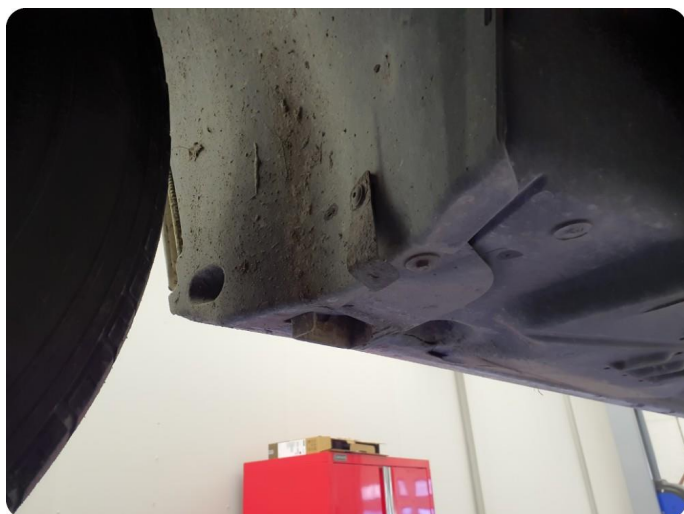
3.2 Beskyttelsesplate skadet/mangler Tillegg skadet og mangler skvettlapp
