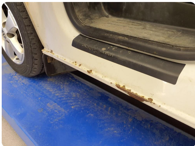
3.1 Øvrige feil Rust, riper, bulker. Hele bilen
