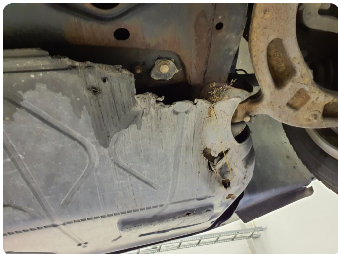
3.2 Beskyttelsesplate skadet/mangler Tillegg skadet og mangler skvettlapp
