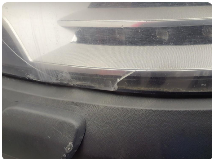
4.1 Defekt/sprukket glass Tillegg riper høyre
