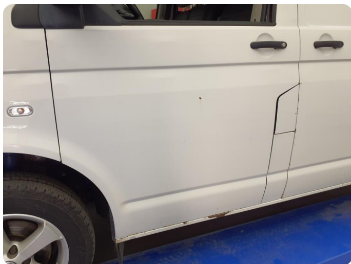
3.1 Øvrige feil Rust, riper, bulker. Hele bilen
