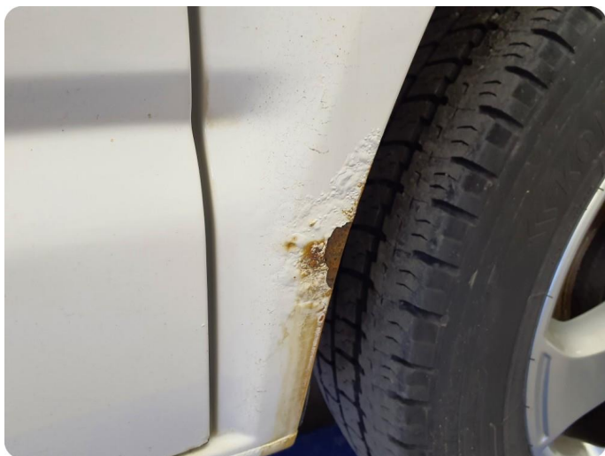
3.1 Øvrige feil Rust, riper, bulker. Hele bilen
