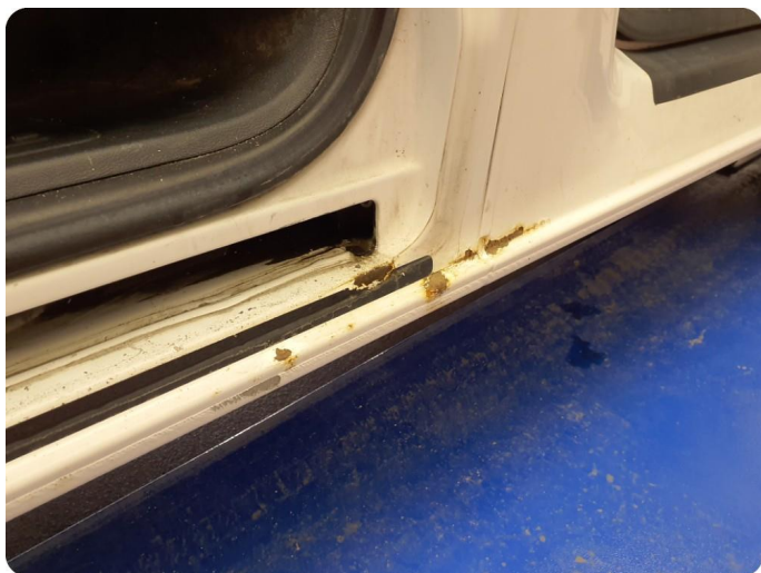
3.1 Øvrige feil Rust, riper, bulker. Hele bilen
