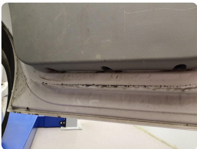
3.3 Øvrige feil Bulker, riper, rust
