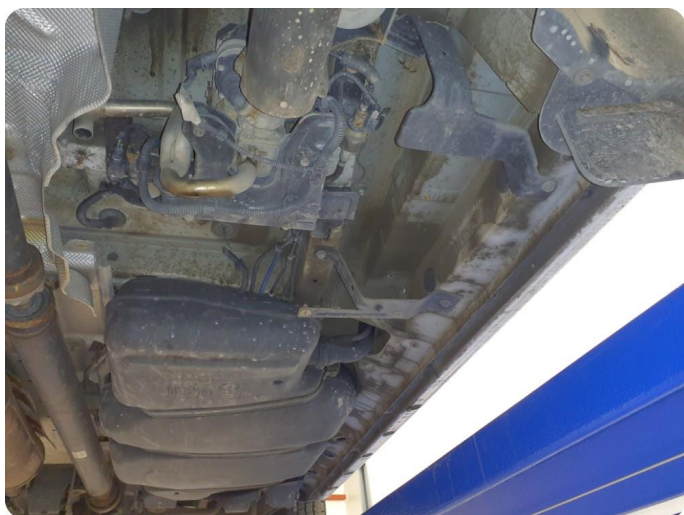
3.2 Beskyttelsesplate skadet/mangler Tillegg skadet og mangler skvettlapp
