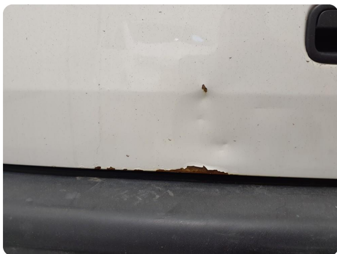
3.1 Øvrige feil Rust, riper, bulker. Hele bilen
