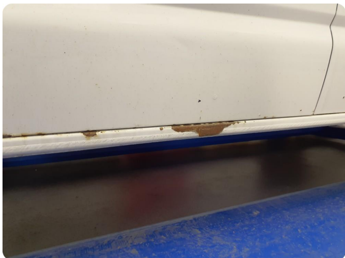
3.1 Øvrige feil Rust, riper, bulker. Hele bilen
