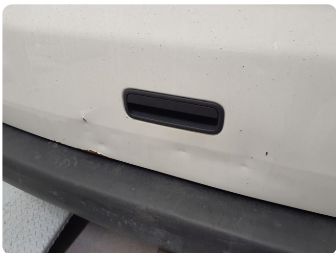
3.1 Øvrige feil Rust, riper, bulker. Hele bilen
