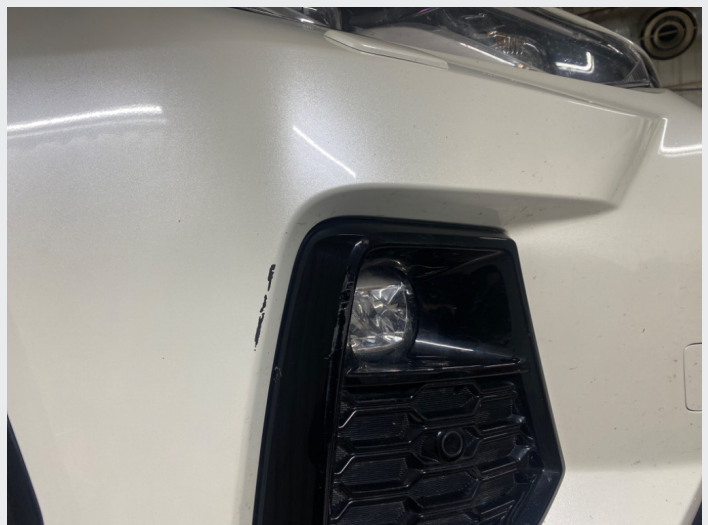
2.8 Lakkskade høre foran, samt skade på plastikk rundt lykt i fanger
