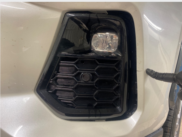
2.8 Lykt i fanger klemt inn høyre foran, samt knekt/sprekk i fanger
