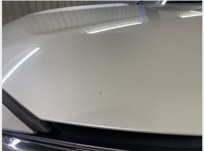
2.3 Noe steinsprut panser
