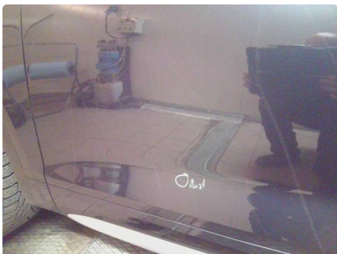
1.3 Steinsprut med rust
