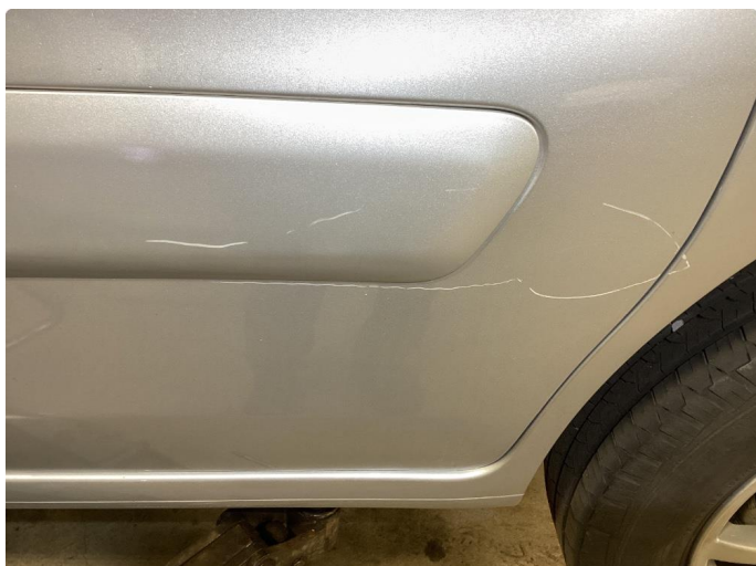
1.1 Overfladiske riper i karosseri, er utbedret 50% med polering og rubbing
