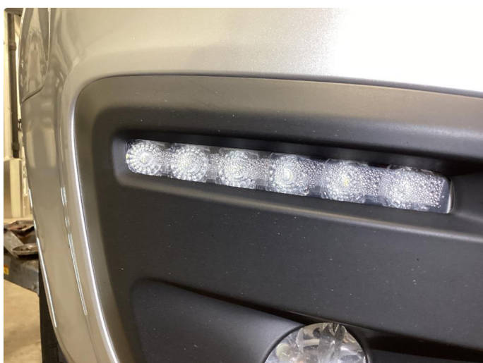
2.1 Dugg i LED markeringslys høyre side fremme når bilen er brukt i regnvær. Viser ikke når bilen har stått inn tørt
