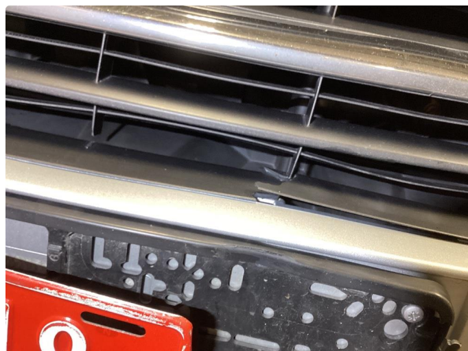
1.3 Sprekk i plast i grill front
