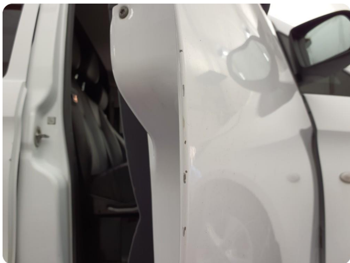
3.4 Flere bulker Tillegg rust , må kontrolleres
