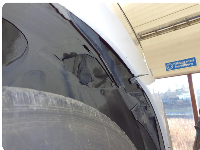
3.7 Steinsprut Tillegg skadet innerskjerm h.f
