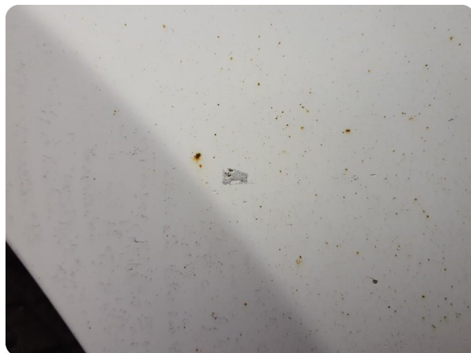
3.7 Steinsprut Tillegg skadet innerskjerm h.f
