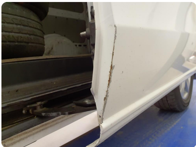
3.4 Flere bulker Tillegg rust , må kontrolleres
