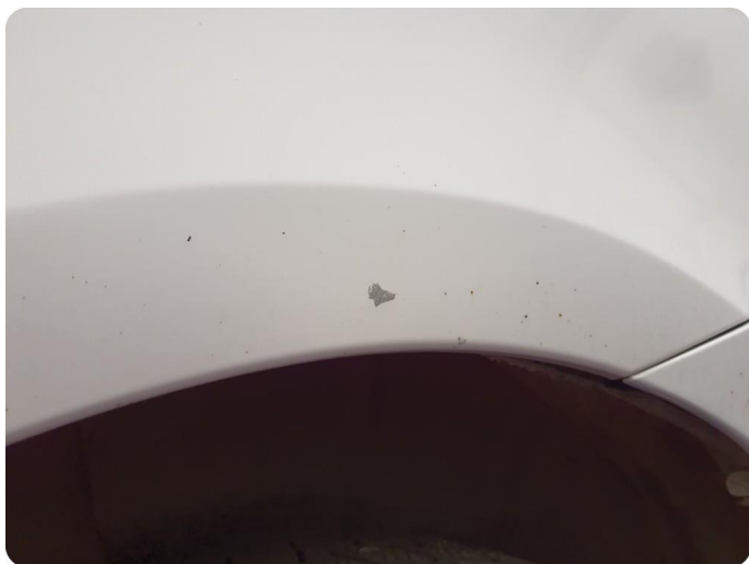
3.7 Steinsprut Tillegg skadet innerskjerm h.f
