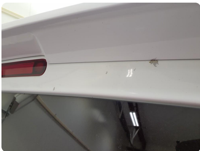
3.6 Rust/korrosjon Tillegg riper og lakkflass
