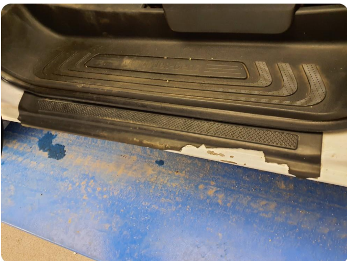
3.10 Slitt innsteg Tillegg rust og plast deksel skadet
