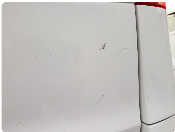
3.6 Rust/korrosjon Tillegg riper og lakkflass
