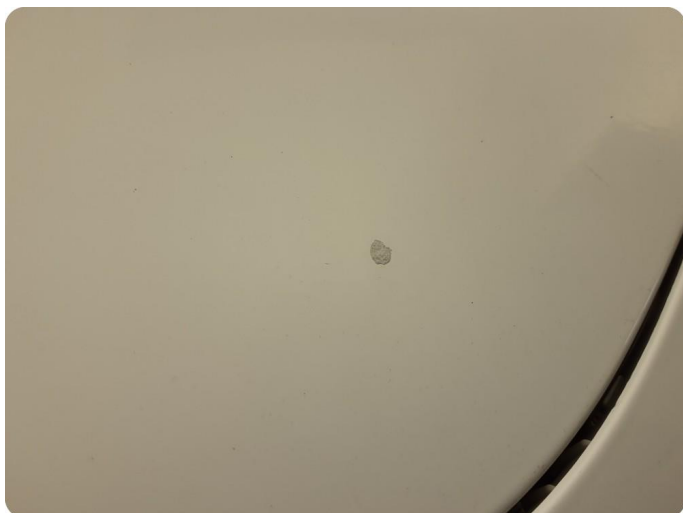
3.7 Steinsprut Tillegg skadet innerskjerm h.f
