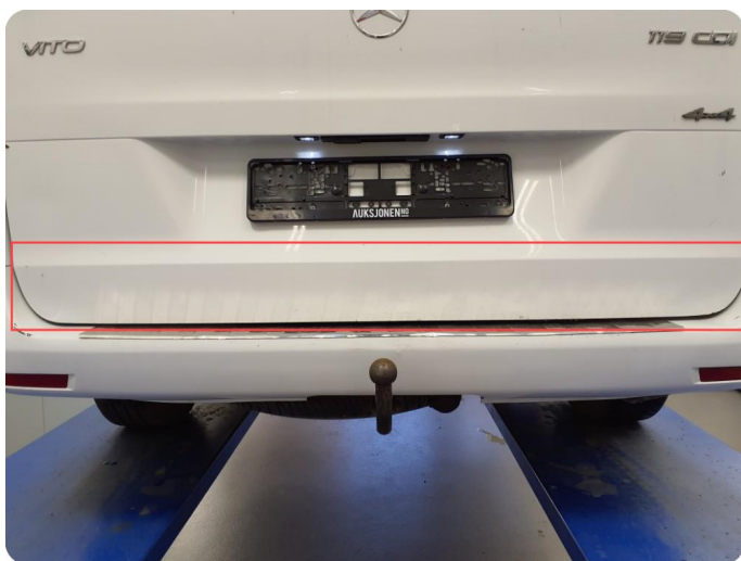
3.6 Rust/korrosjon Tillegg riper og lakkflass
