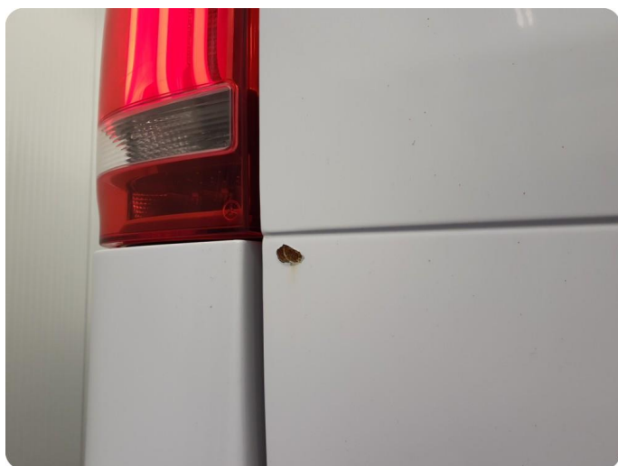
3.6 Rust/korrosjon Tillegg riper og lakkflass
