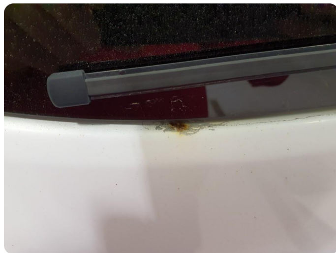
3.6 Rust/korrosjon Tillegg riper og lakkflass
