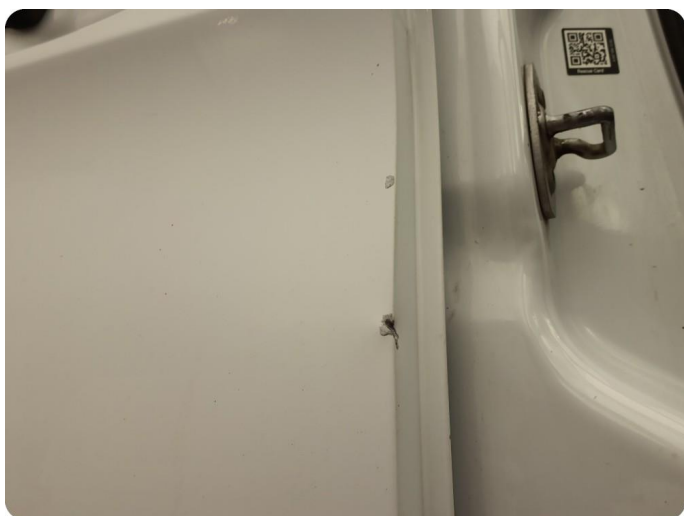
3.4 Flere bulker Tillegg rust , må kontrolleres
