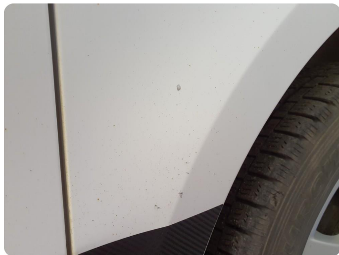
3.7 Steinsprut Tillegg skadet innerskjerm h.f
