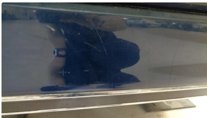
1.5 Mye riper og slitasje samt ødelagt bakfanger folie
