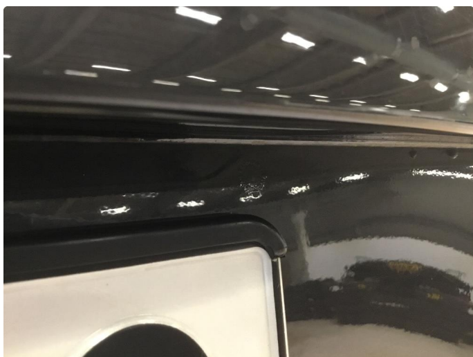
1.8 Bakluke - lakkblærer og rust
