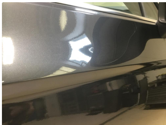
1.7 Høyre dør foran, bulk
