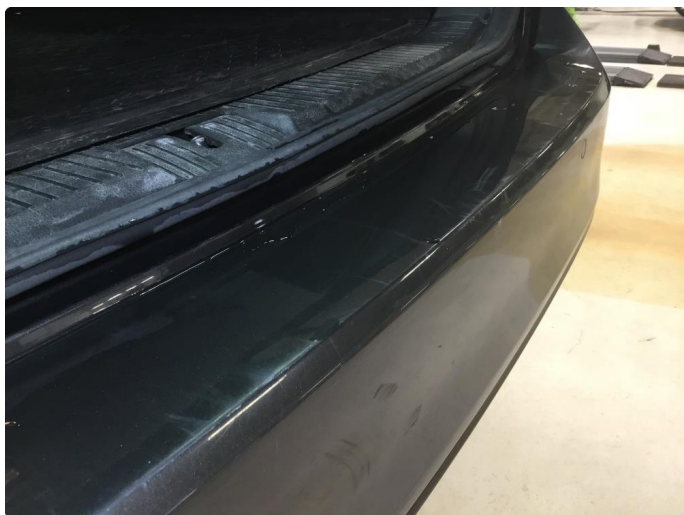
1.13 Støtfanger bak - mye riper og slitasje
