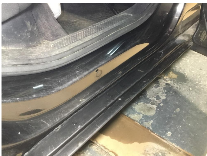
1.12 Bulk høyre innsteg bak
