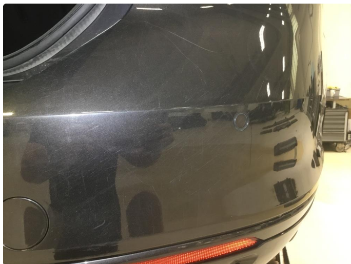
1.13 Støtfanger bak - mye riper og slitasje
