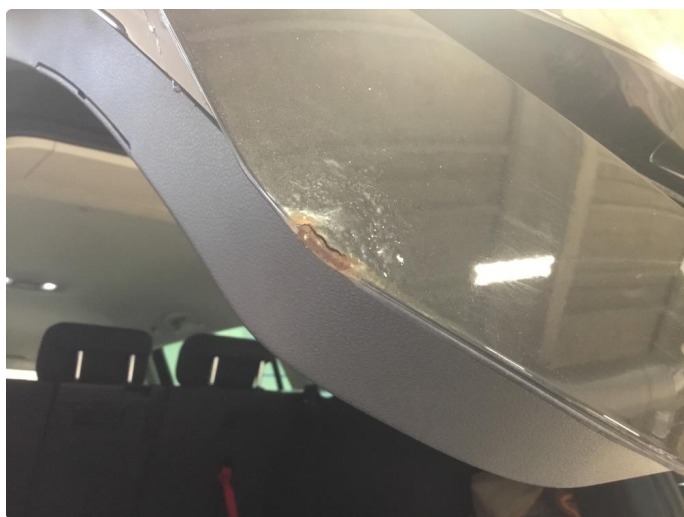
1.8 Bakluke - lakkblærer og rust
