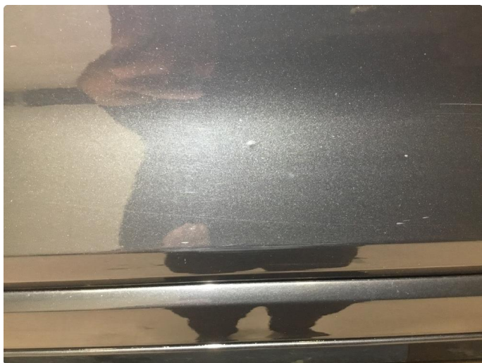
1.5 Venstre dør bak - lakkblærer
