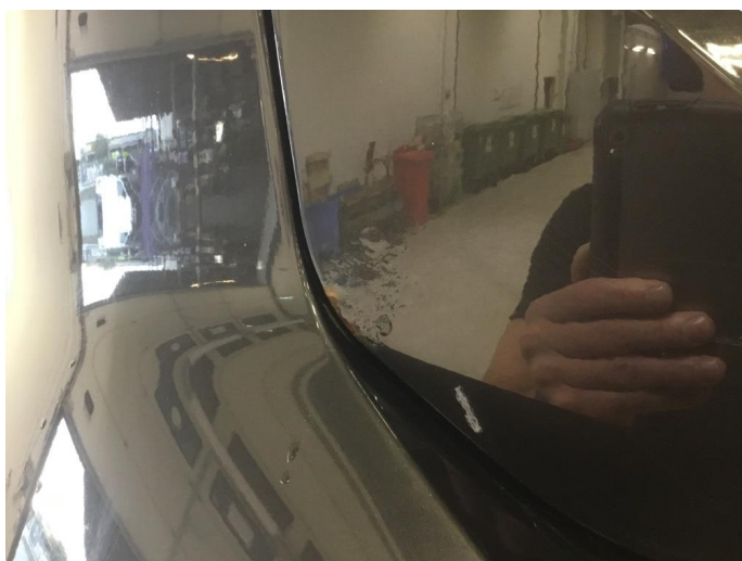
1.8 Bakluke - lakkblærer og rust
