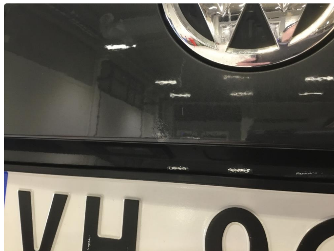
1.8 Bakluke - lakkblærer og rust
