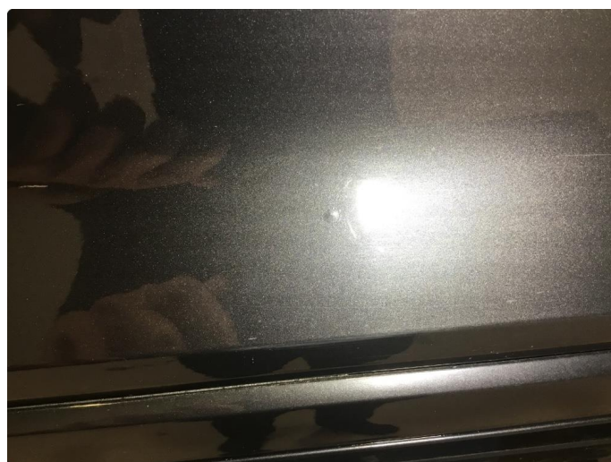
1.5 Venstre dør bak - lakkblærer
