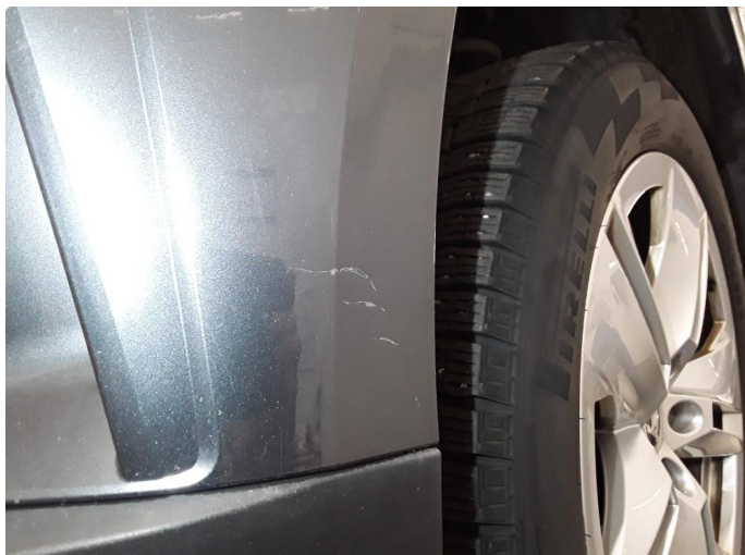
1.2 Ripe(r) støtfanger venstre side foran. Flekkes med lakkstift.
