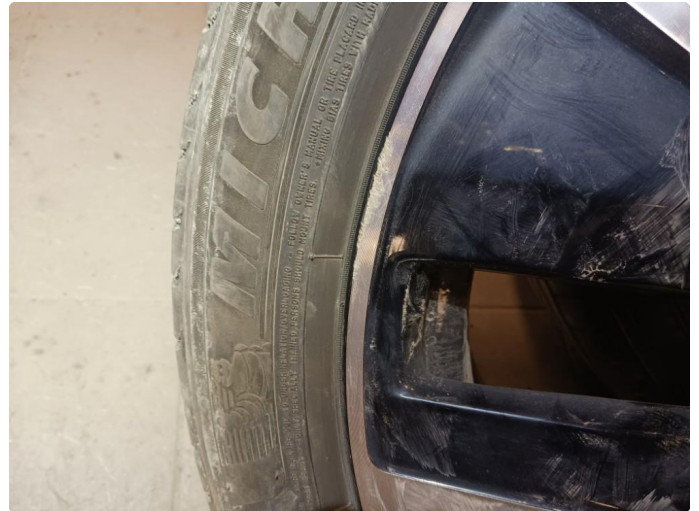
1.1 Slitasje høyre bakfelg
