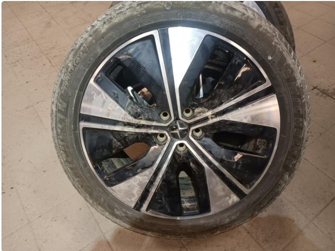
1.1 Slitasje høyre bakfelg
