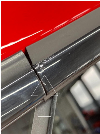
1.5 Noe korrodering på listverk tak og dørterskler, notert
