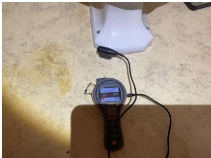
Høye fuktverdier i tilfarergulv.
