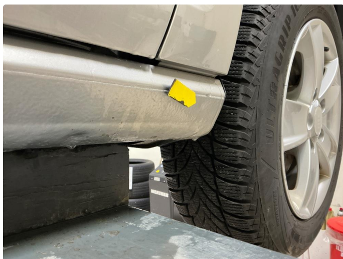
1.8 Høyre side, bulk
