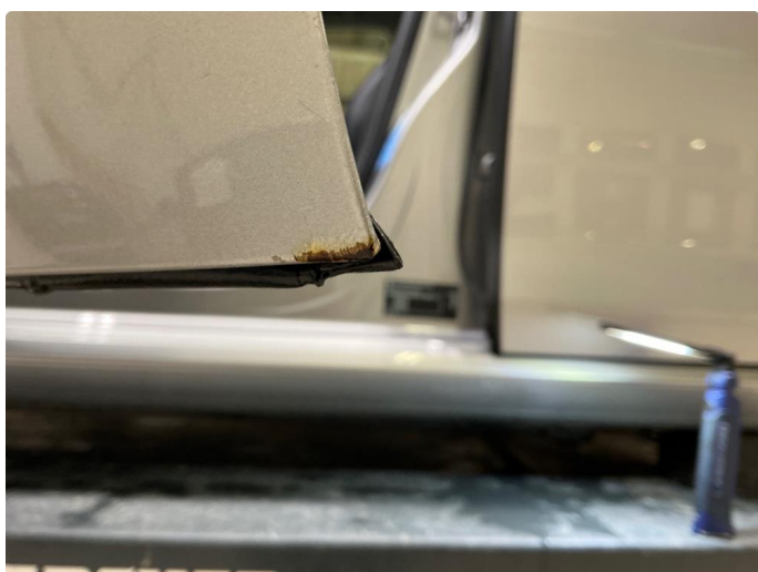
1.4 Høyre dør foran, rust
