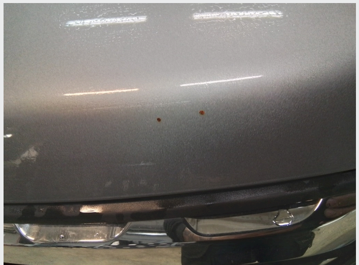
2.3 Rusta steinsprut panser
