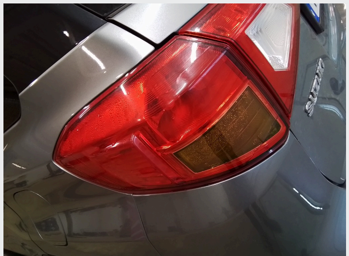
3.2 Sprekk og fukt I baklykt ytre vb
