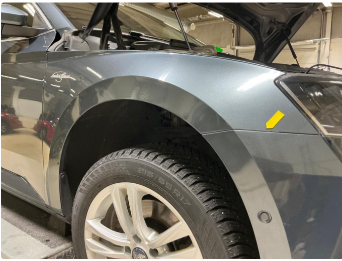
1.1 Noe rust / blærer rundt om. Mangler lakk i kant på h.fs. Bilen er delvis omlakkert. Sig på bakluke.
