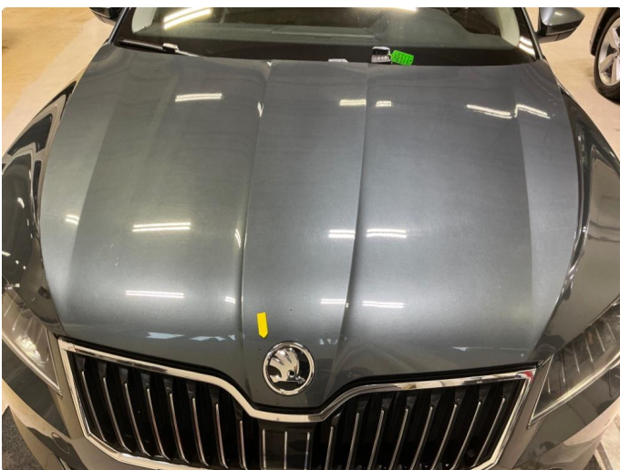
1.2 Noen steinsprutskader på panser. Pensles. Noen er penslet fra før.
