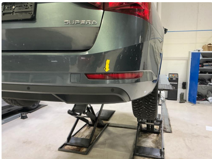
2.1 Sprekk i lykt / refleks fanger bak h.s.
