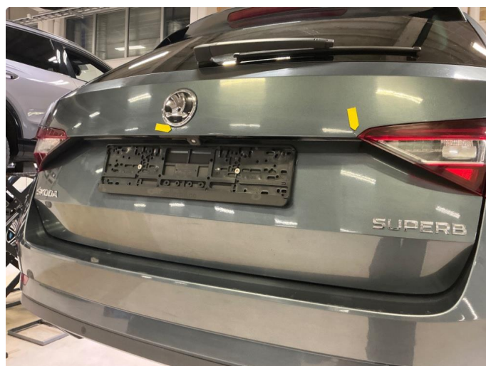
1.1 Noe rust / blærer rundt om. Mangler lakk i kant på h.fs. Bilen er delvis omlakkert. Sig på bakluke.
