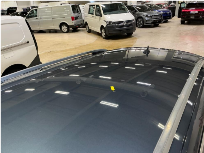
1.9 Steinsprut med rust
