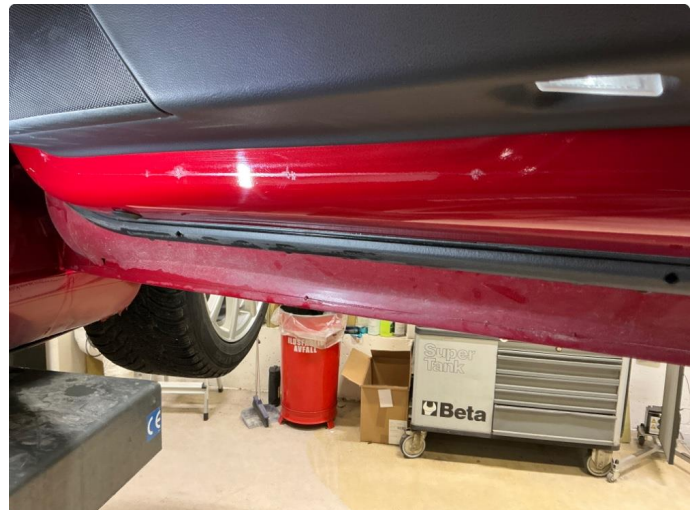
1.2 Korrosjon innvendig alle fire dører under dørkledning
