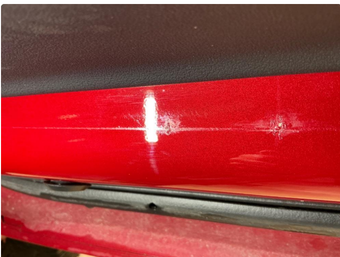
1.2 Korrosjon innvendig alle fire dører under dørkledning
