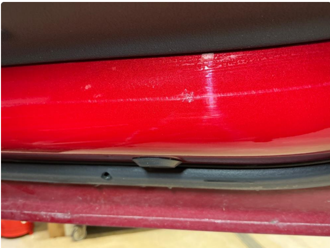
1.2 Korrosjon innvendig alle fire dører under dørkledning
