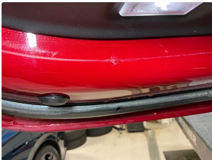
1.2 Korrosjon innvendig alle fire dører under dørkledning
