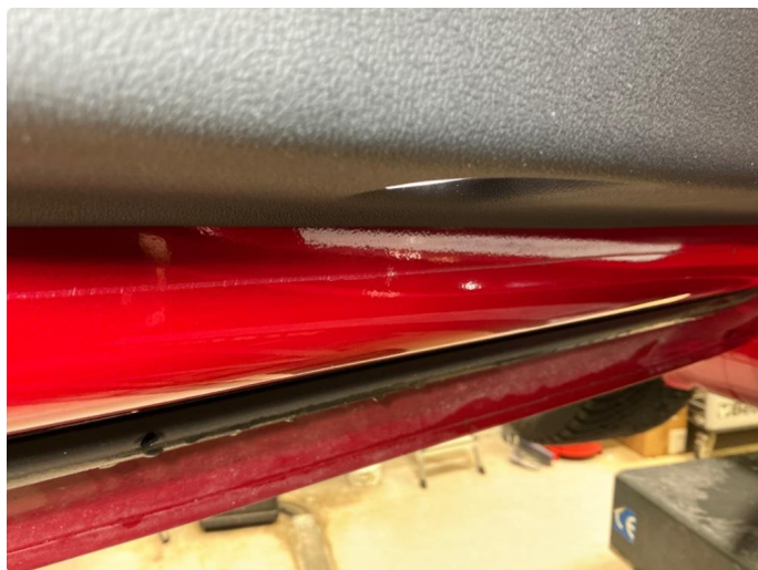
1.2 Korrosjon innvendig alle fire dører under dørkledning
