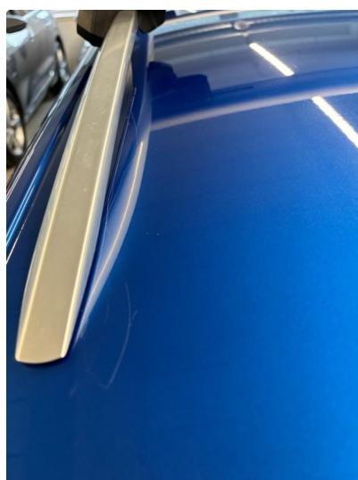
1.5 Noe riper på tak høyre side.
