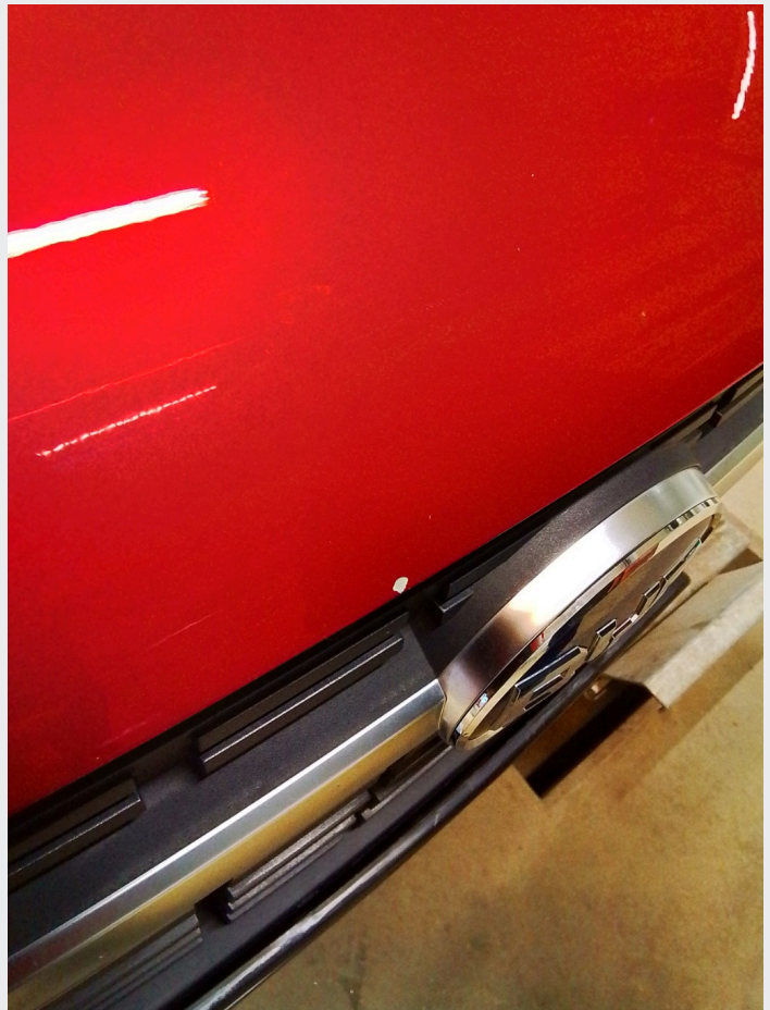
2.3 Steinsprut på panser
