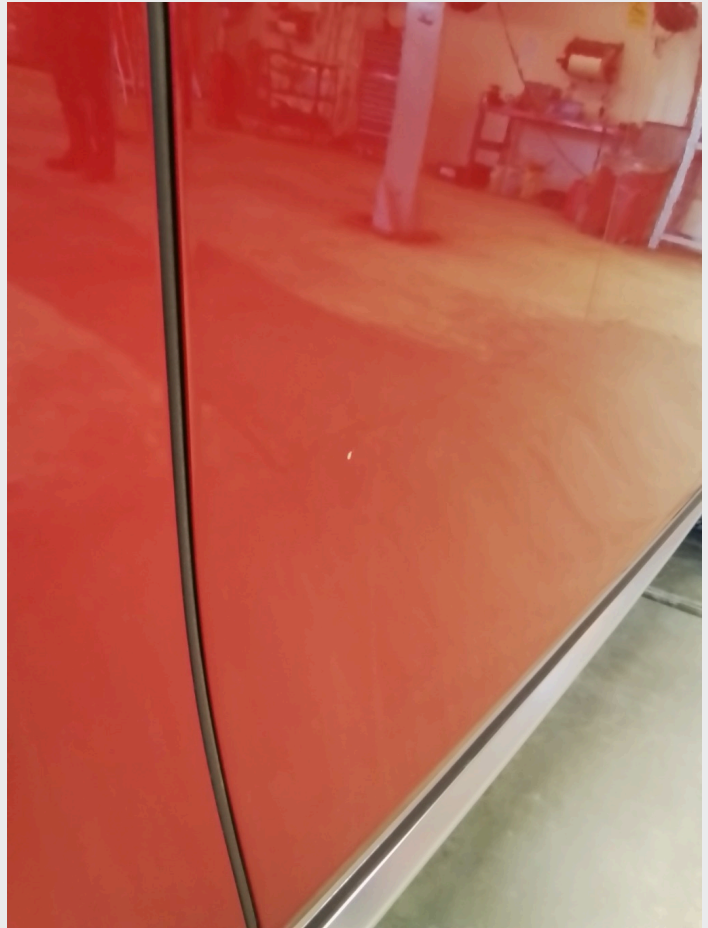
2.5 Liten lakkskade i bakkant av dører venstre foran og venstre bak
