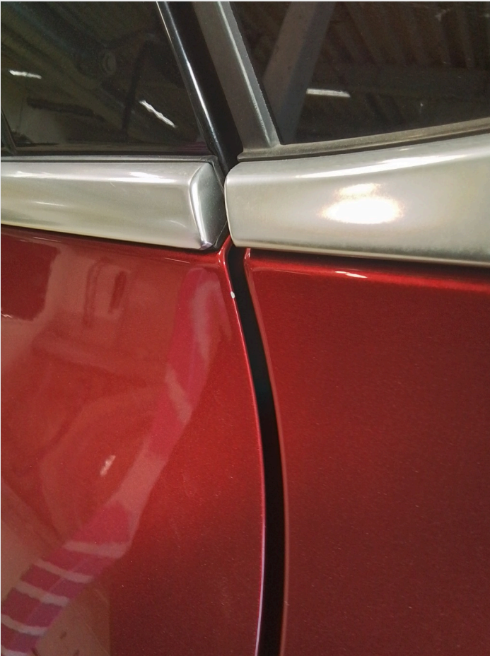
2.5 Liten lakkskade i bakkant av dører venstre foran og venstre bak
