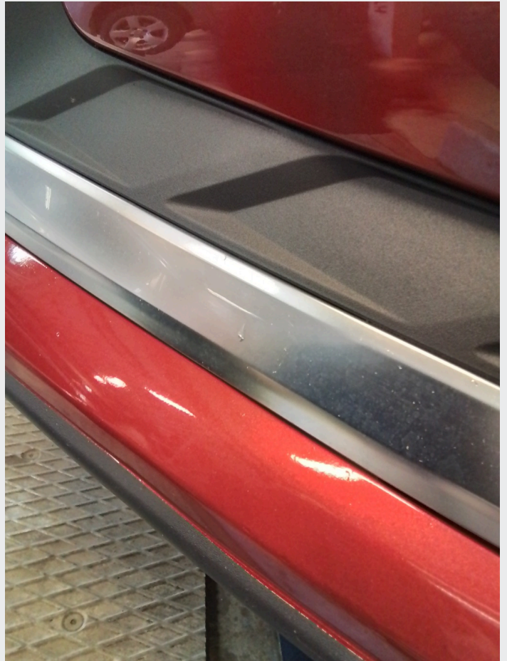
2.8 Steinsprut i kromlist nedkant begge sider frontfanger
