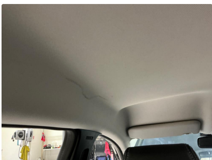
2.1 Noen flekker på taktrekk.
