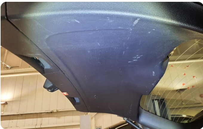
5.1 Skadet/merker etter utstyr Se lakksår
