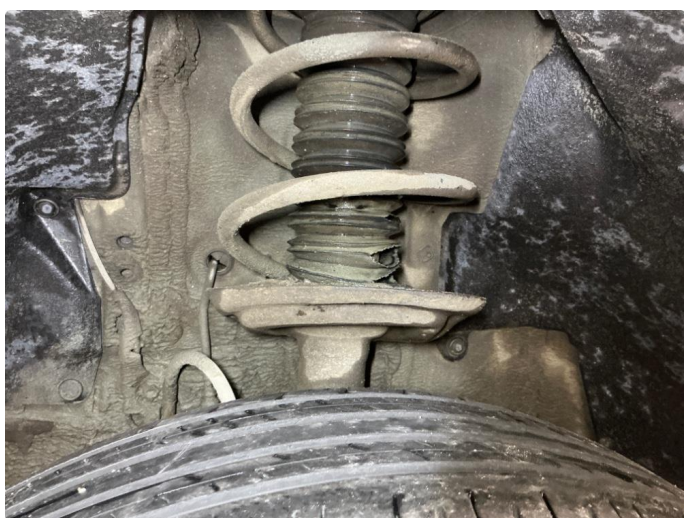
2.1 Skade på støvmansjetter begge foran.....
