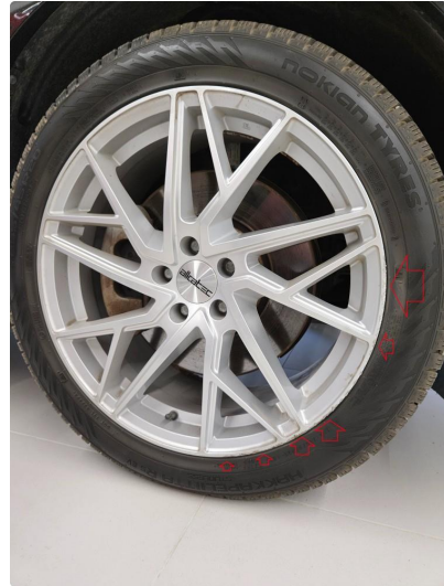
1.1 Noe skrubbermerker på ytre kant, alu. vinterfelg, h.side foran
