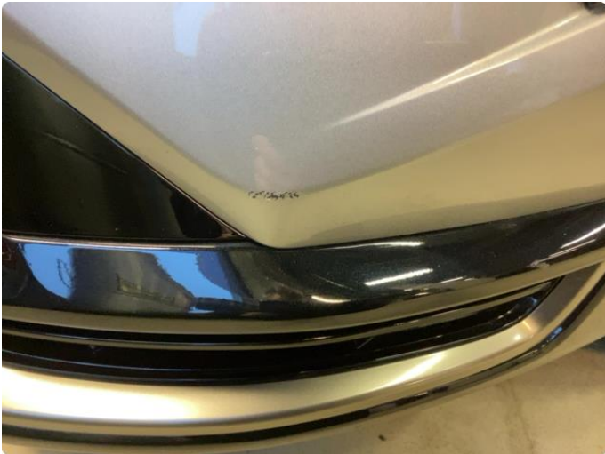
1.1 To små lakkskader på frontfanger V/Side
