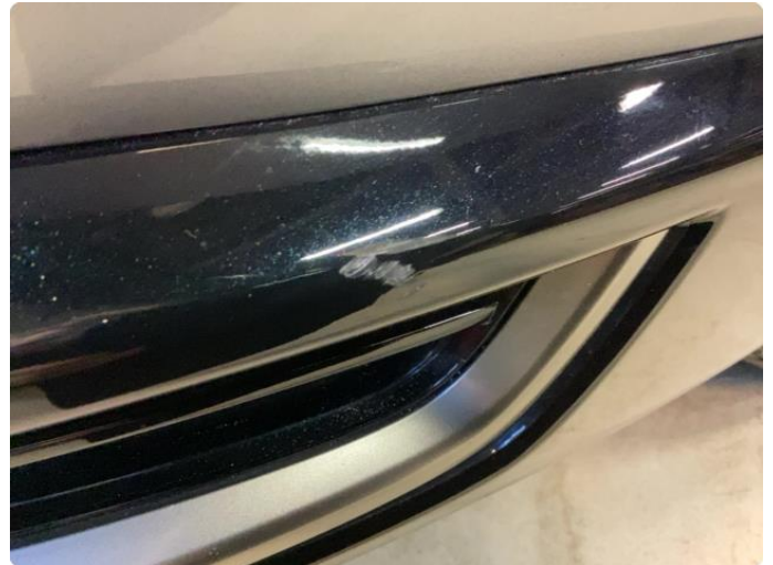
1.1 To små lakkskader på frontfanger V/Side
