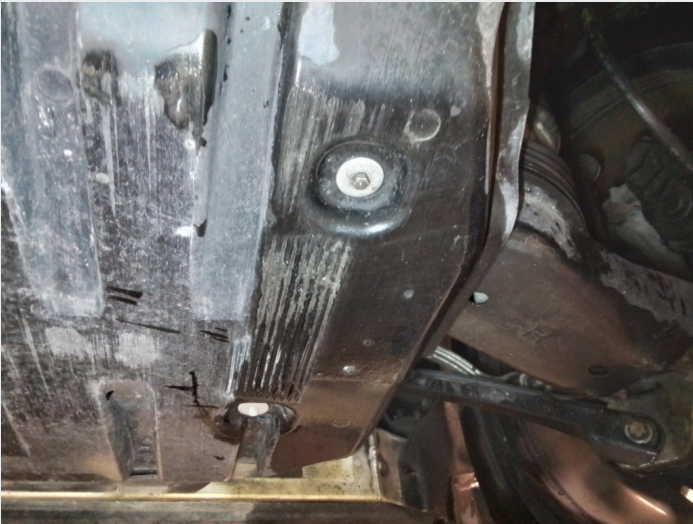
2.2 Skade på plastdeksel under bakre motor
