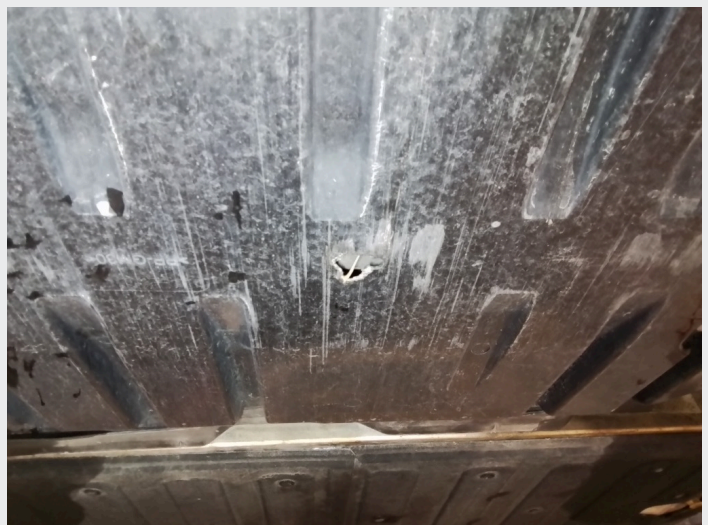
2.2 Skade på plastdeksel under bakre motor
