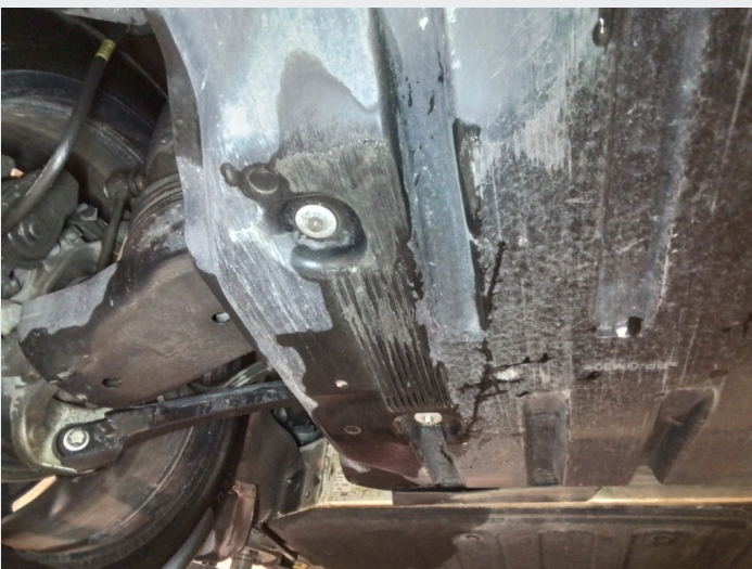
2.2 Skade på plastdeksel under bakre motor
