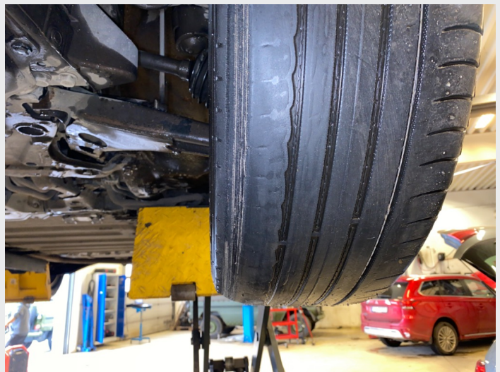
2.17 Dekk foran sliter innside, mye venstre side
