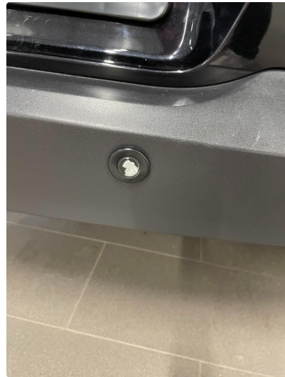
1.4 Avskaling lakk parksensor bak
