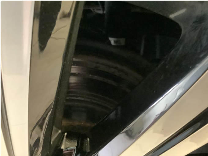
1.1 Noe Overflate rust på Skiver Bak
