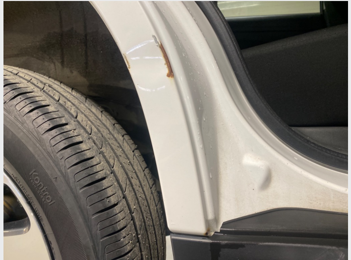
2.7 Høyre bakskjerm bulk og rustskade
