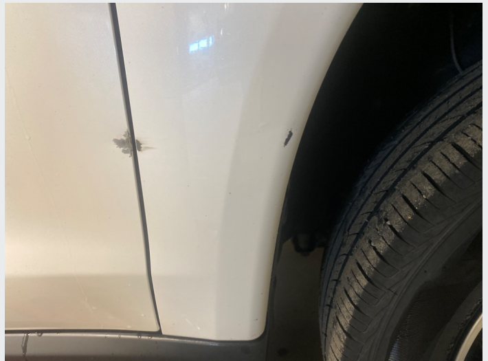
2.7 Høyre forskjerm, lakkskade
