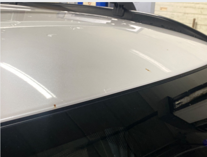
2.10 Steinsprut/rustskader tak, ved frontrute
