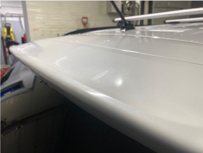
2.5 Bakluke, over rute, lakkskader/striper
