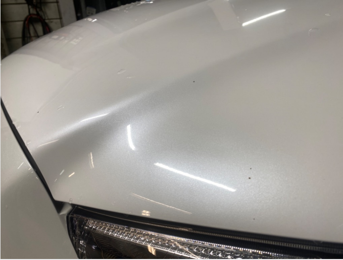
2.3 Steinsprut med rustskader
