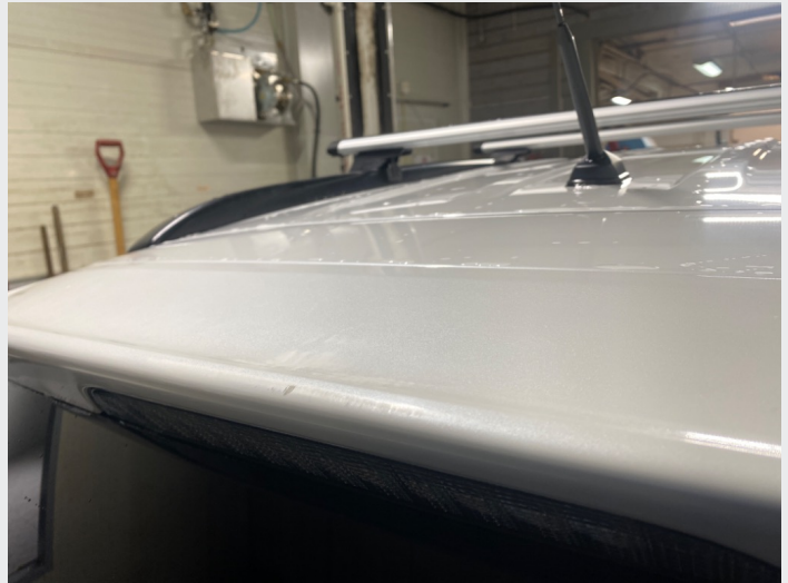
2.5 Bakluke, over rute, lakkskader/striper
