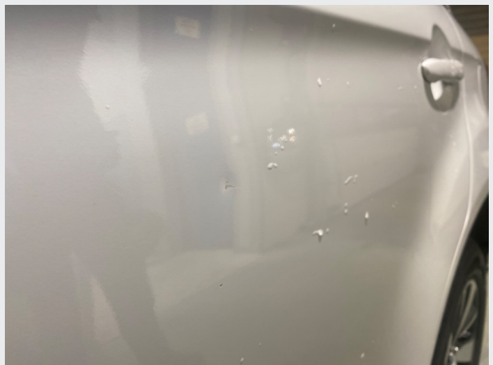
2.5 Venstre bakdør, bulk og lakkskade
