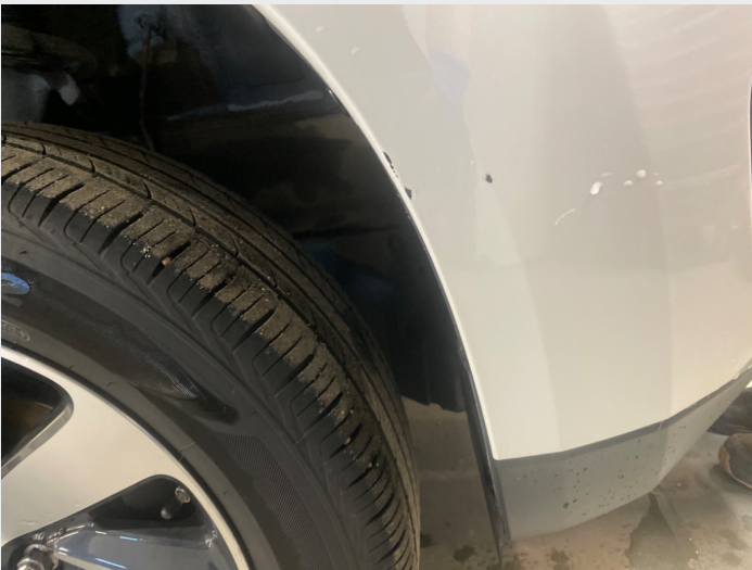
2.8 Støtfanger foran, høyre hjørne, lakkskade
