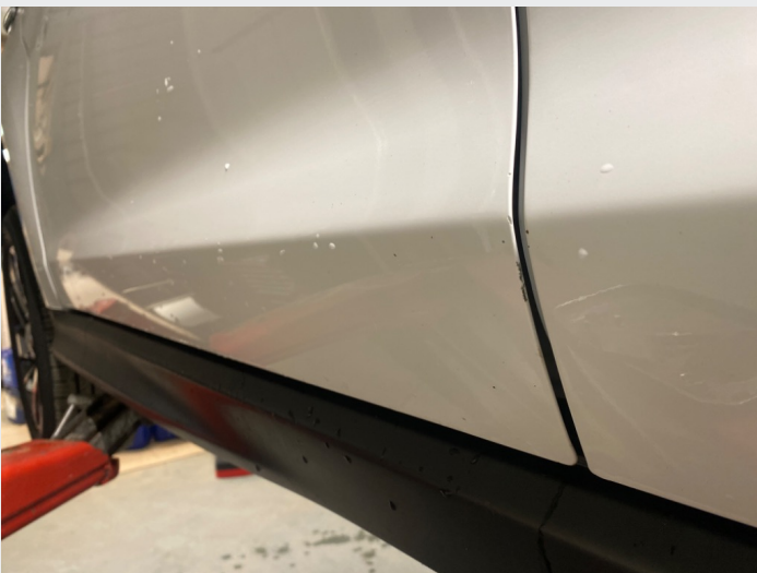
2.5 Venstre fordør, hakk/lakkskader
