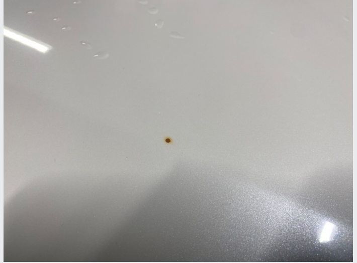
2.3 Steinsprut med rustskader
