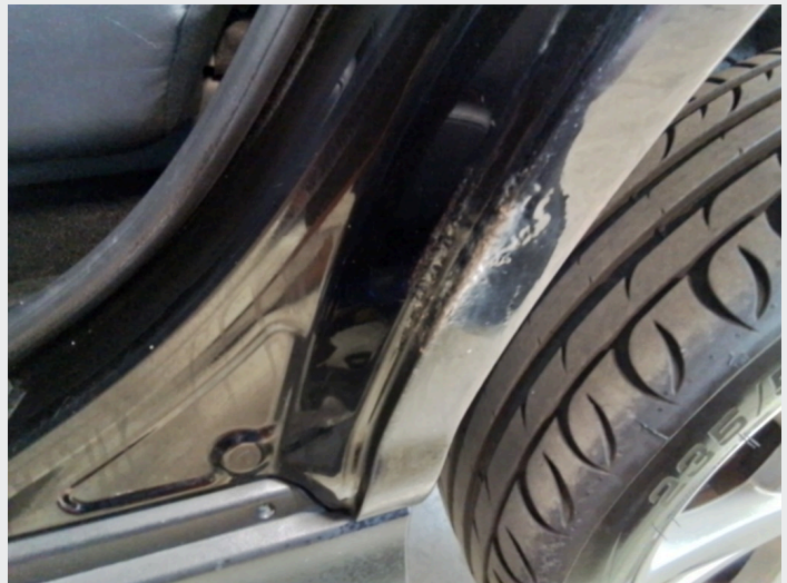
2.7 Rust høyre bakskjerm
