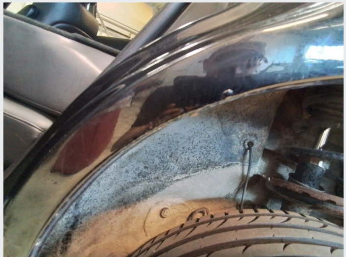
2.7 Rust høyre bakskjerm
