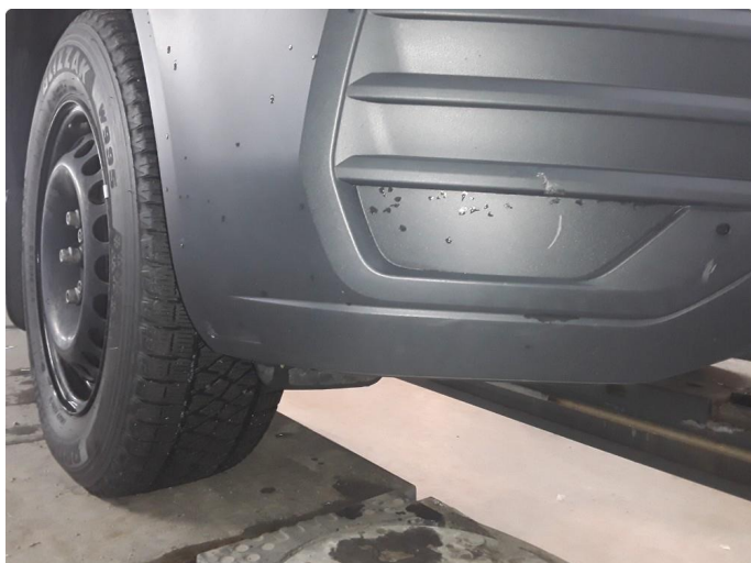
1.3 Knast Ripe I støtfanger foran. I sort plast,
