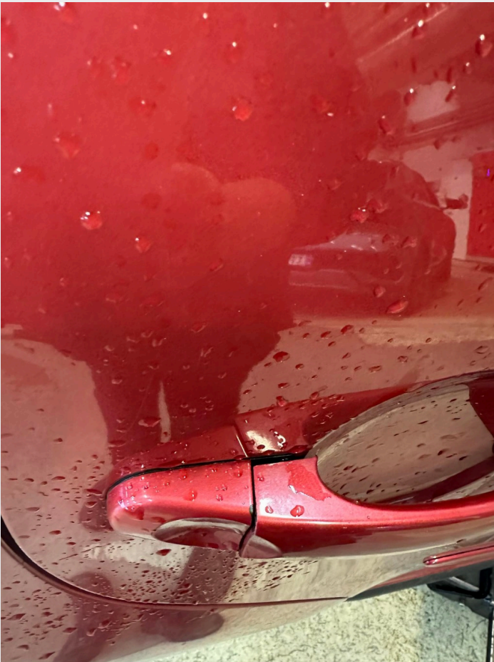
2.5 Dørhåndtak høyre bak flukter ikke.
