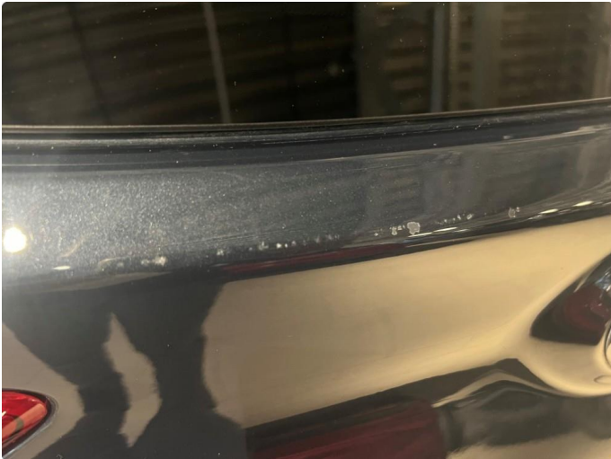
1.1 Skrammer etter bakluke som har tatt i overhengende last. Utbedret med lakkstift
