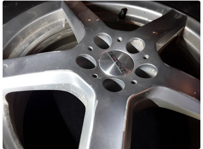
1.2 2 noe kantkjørte vinterfelger.
