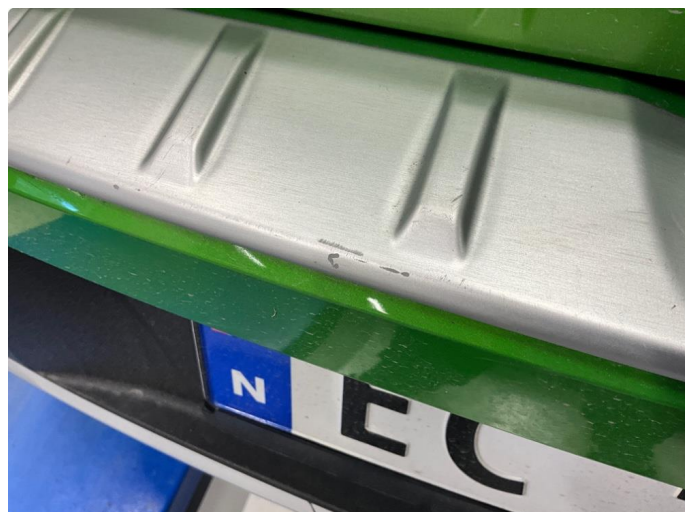
1.1 Noe riper i list innlastningsone bakfanger
