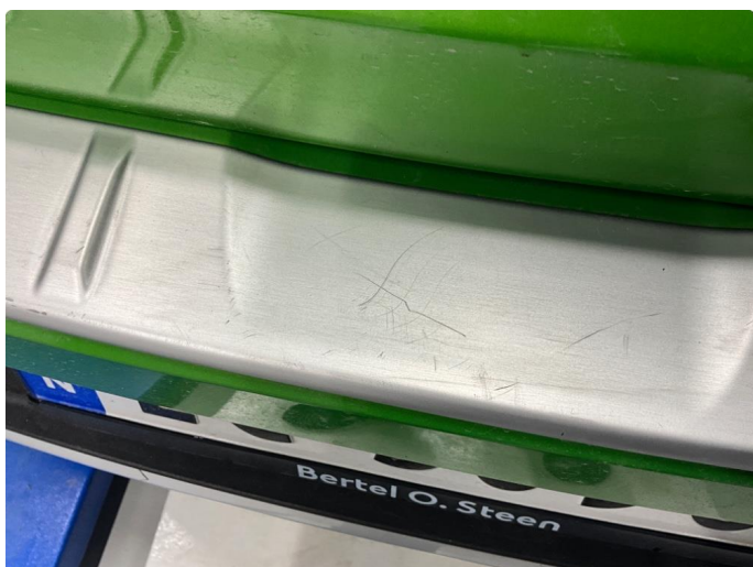
1.1 Noe riper i list innlastningsone bakfanger
