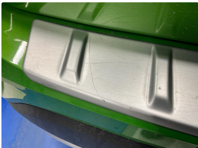
1.1 Noe riper i list innlastningsone bakfanger
