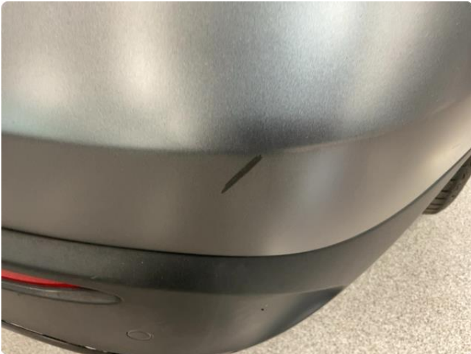
1.1 Ripe(r) ned til grunning.
