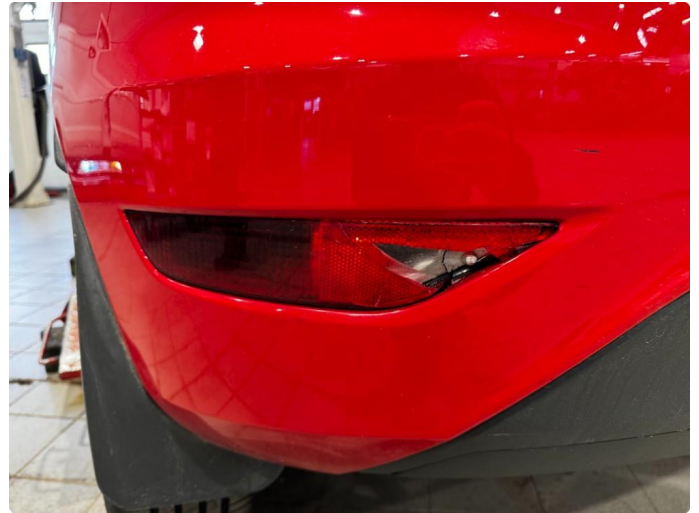
2.1 Skade på refleks
