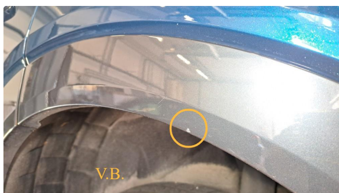
1.1 Noen steinsprut og småriper
