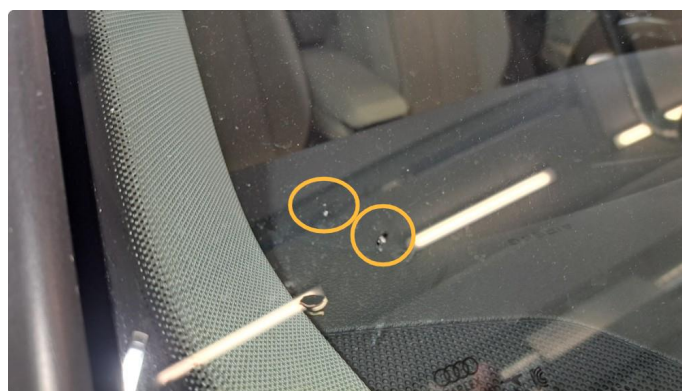
1.8 Små steinsprut utenfor synsfelt.
