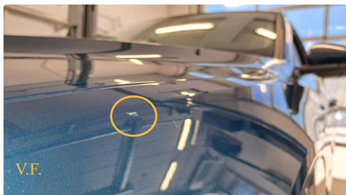
1.1 Noen steinsprut og småriper
