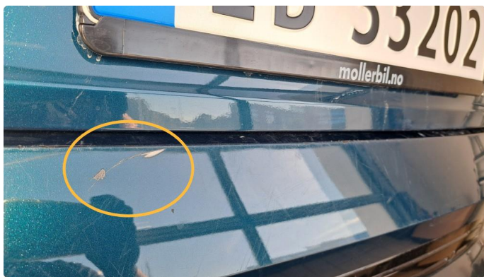
1.5 Riper ved lastekant.
