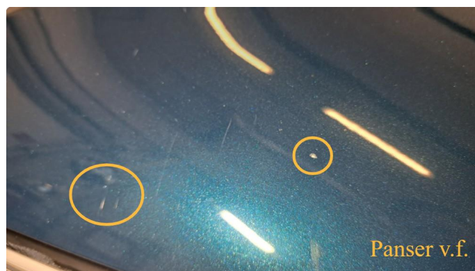
1.1 Noen steinsprut og småriper
