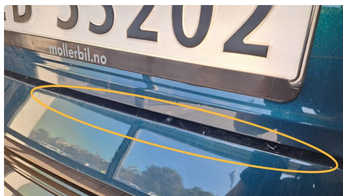
1.5 Riper ved lastekant.
