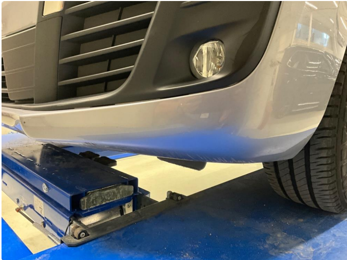
1.1 Ripe(r) ned til grunning
