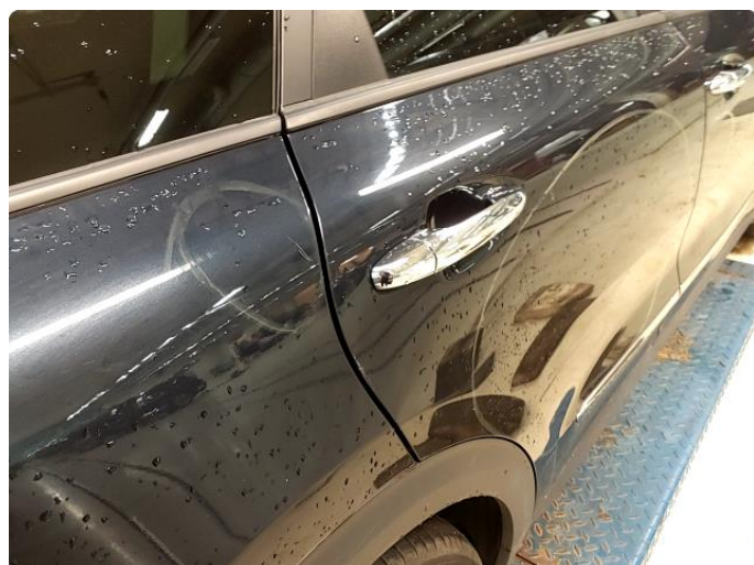
1.3 Ripe(r) ned til grunning
