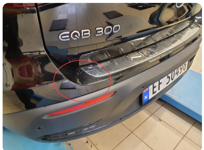
3.4 Ripe(r) ned til grunning
