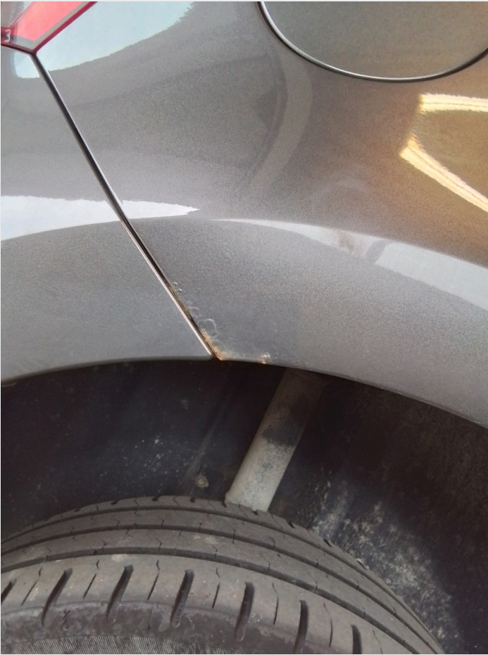
2.7 Rust rundt hjulbuer bak
