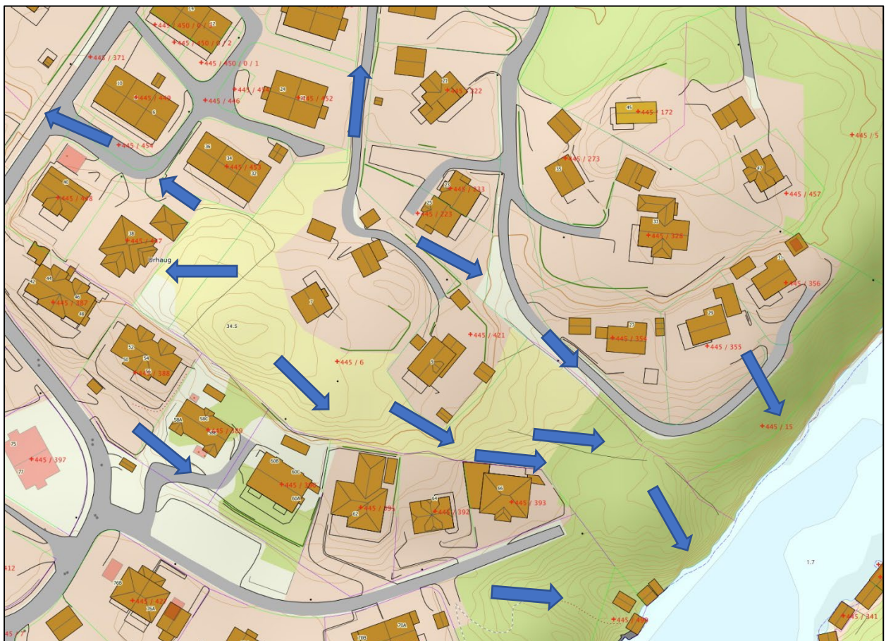
Figur 4. Lokalt nedbørsfelt og avrenning frå dette.
