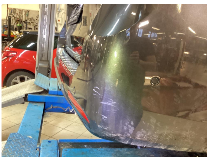
1.3 Ripe(r) ned til grunning
