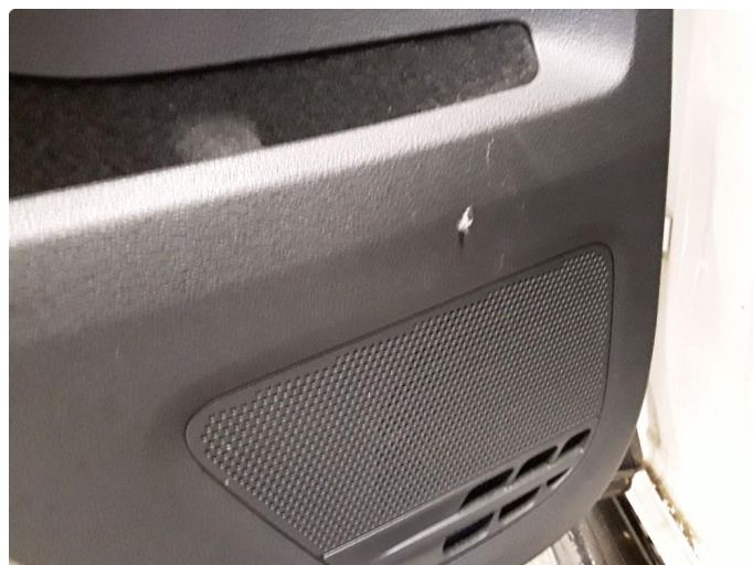
2.1 Et lite rift i plastikk dørtrekk i venstre bakdør. Normal bruksslitasje varebil.
