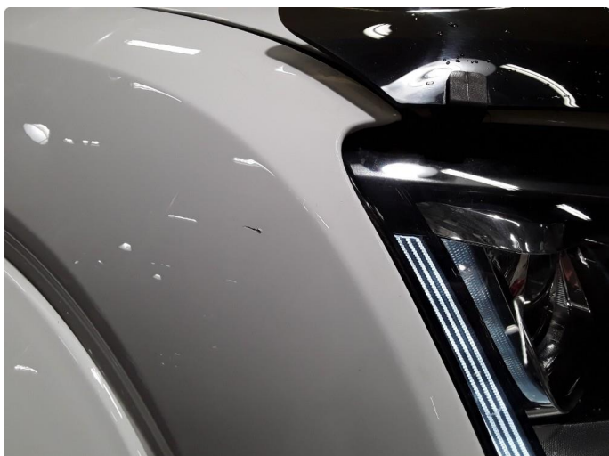
1.1 En liten ripe på høyre forskjerm. Flekkes med lakkstift.
