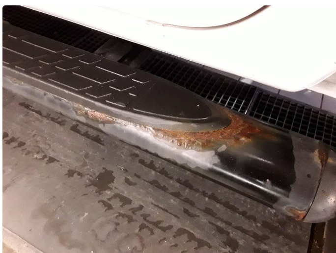
3.1 Ettermontert stigtrinn har rust/korrosjon
