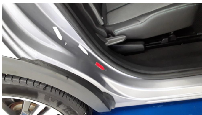
1.1 Noen riper og småbulker
