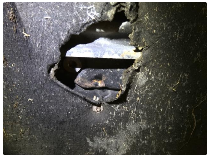
7.1 Øvrige feil. plast deksel under girkasse skadet og liten bulk i bunnpanne.
