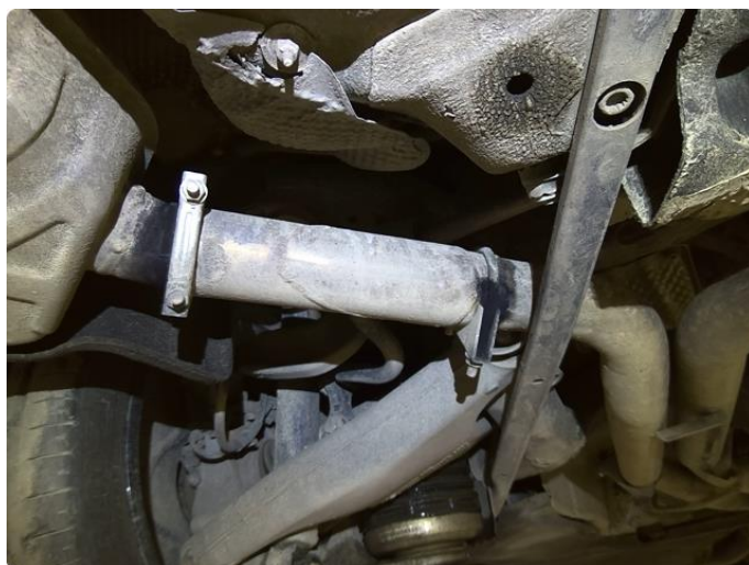
4.2 Øvrige feil. Uoriginalt eksosanlegg. Vil ikke bli byttet før salg.
