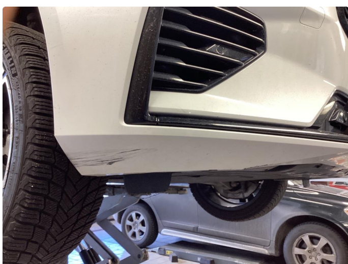
2.5 Ripe(r) ned til grunning. Utført
