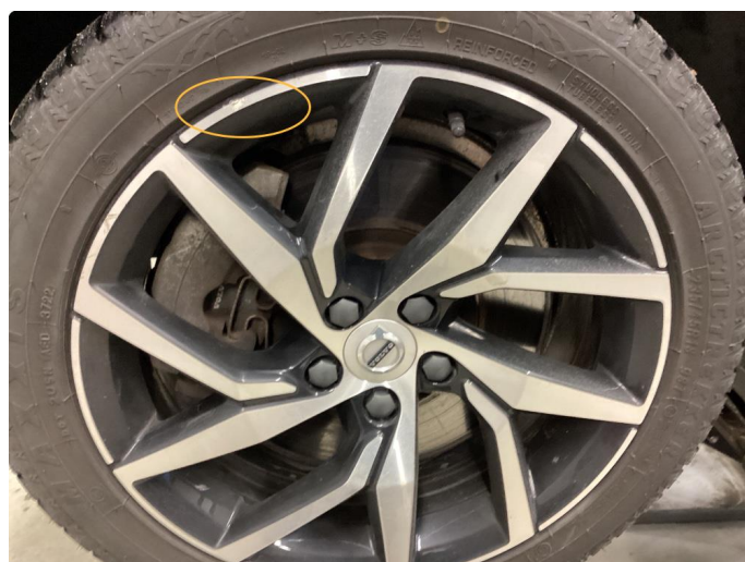
1.4 Kantkjørt felg. Utført
