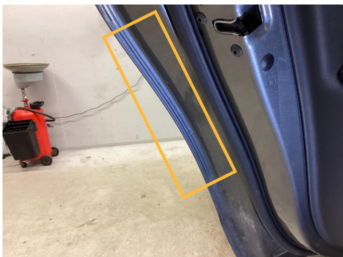
1.1 Rust i fals. Utført
